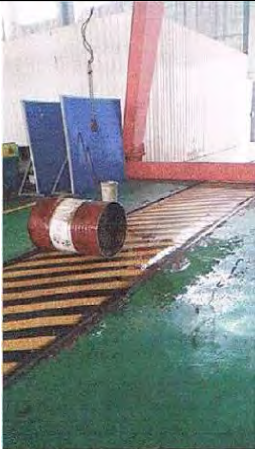
(3) 突然脱钩废油溢出
